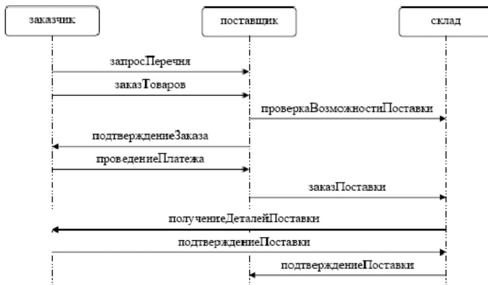
Рис. 4.18. Диаграмма последовательности, соответствующая разговору трех служб, показанному на Рис. 4.17.
