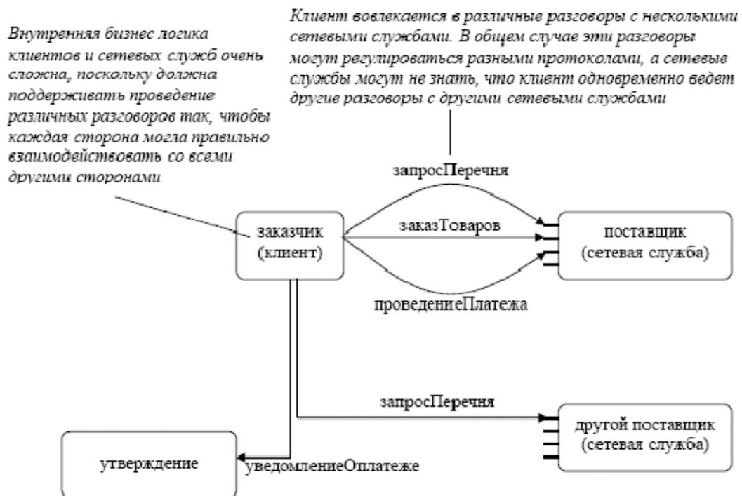
Рис. 5.1. Клиенты могут участвовать в различных разговорах с разными сетевыми службами.
