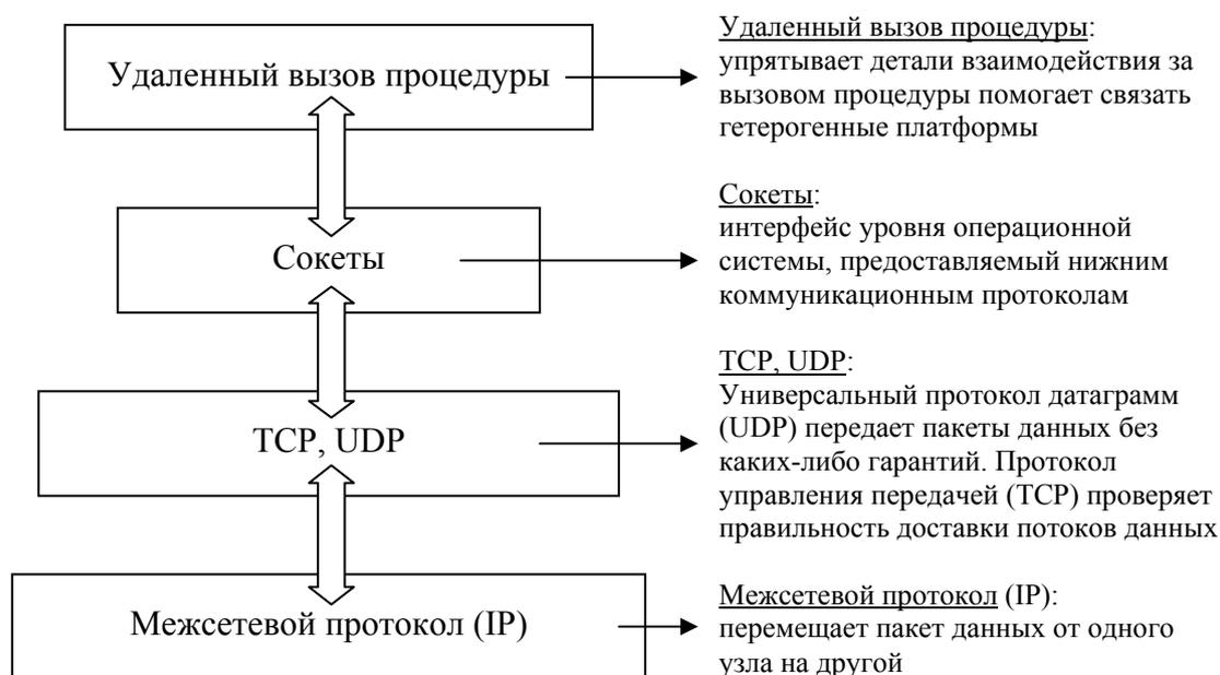
Рис. 2.1. Удаленный вызов процедуры как программная абстракция, построенная на базе других коммуникационных слоев.
