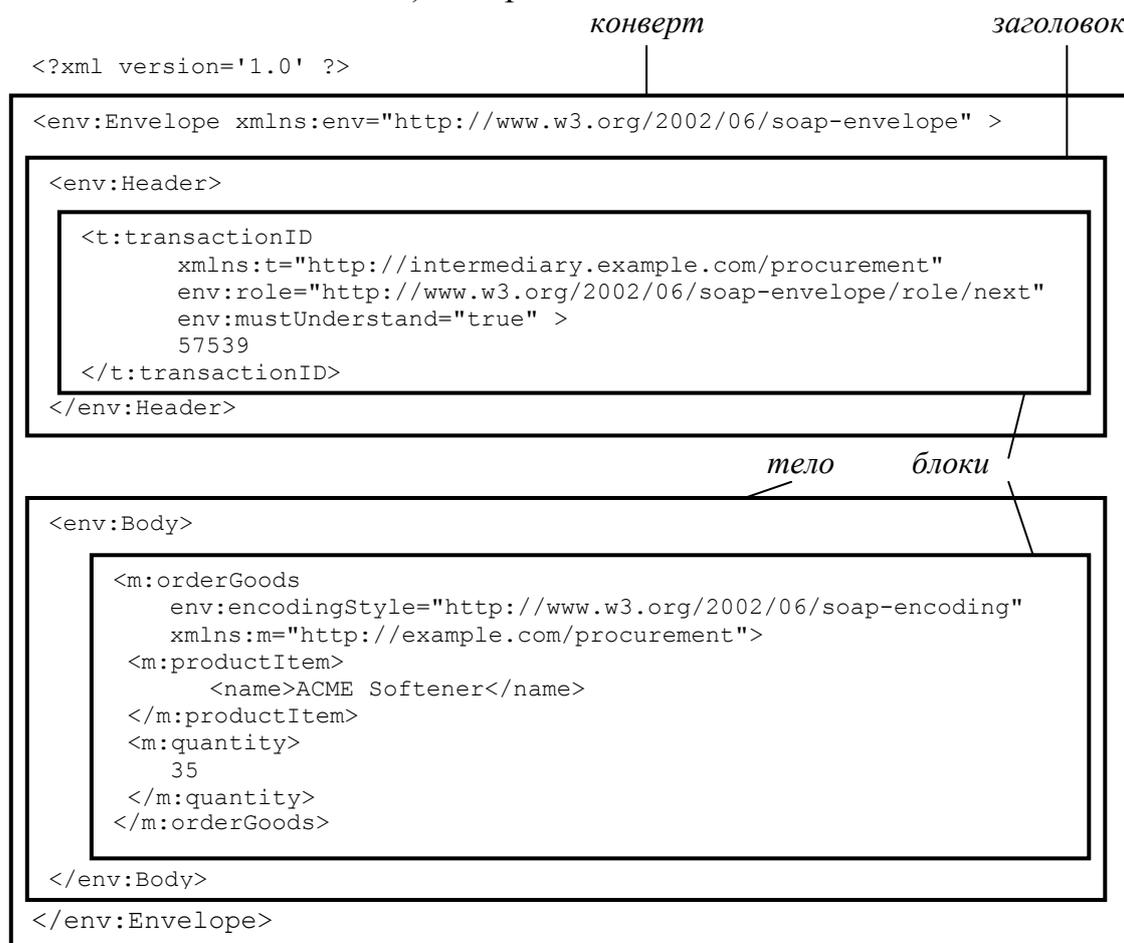
Рис. 4.7. Пример XML-сообщения протокола SOAP, имеющего в заголовке один блок, предназначенный для обработки промежуточным узлом.
