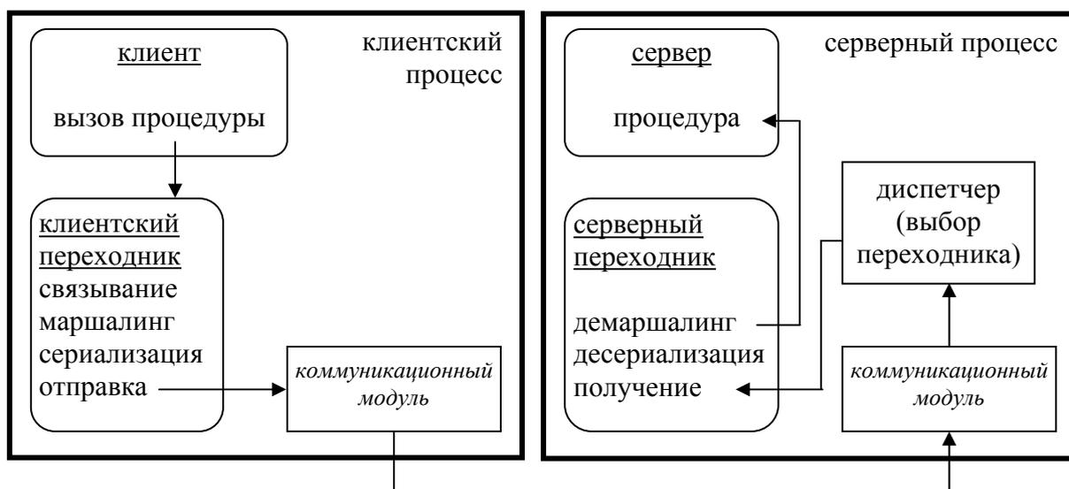
Рис. 2.4. Принцип работы модели RPC.
