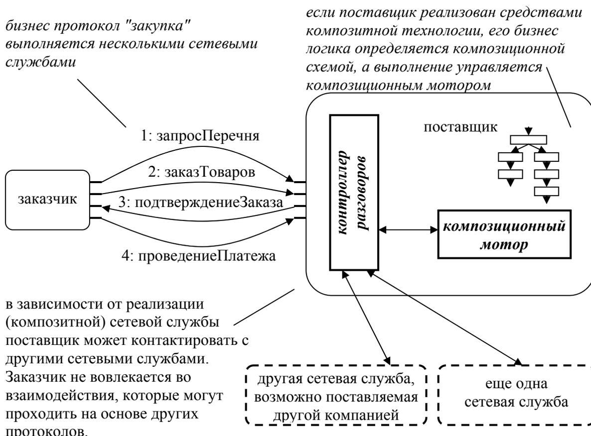
Рис. 5.5. Композиция и координационные протоколы имеют разные области применения: внешние взаимодействия и внешняя реализация.
